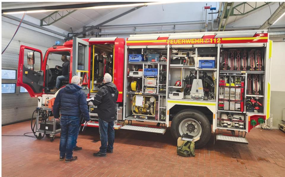
Das neue Löschfahrzeug ist von der Firma Ziegler auf einem Mercedes Atego mit Allradantrieb aufgebaut, es hat eine Motorleistung von 272PS.
